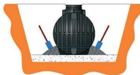
Obrázek: Hutnění prostoru pod nádrží
