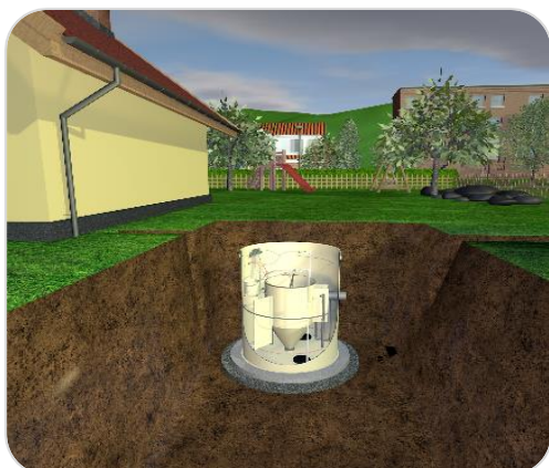
Obr. a3) Umístění ČOV na podkladní beton
