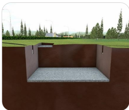
Obr. b1) Zhutněné štěrkové lože
