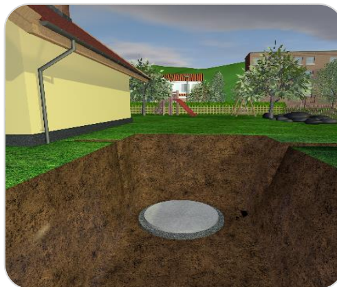
Obr. a2) Podkladní beton
