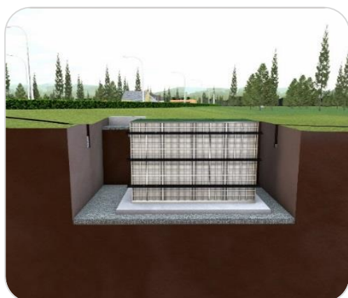
Obr. b3) Umístění ČOV na podkladní beton
