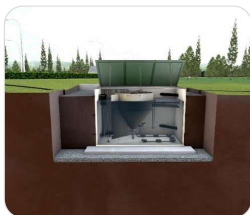
Obr. b6) Napouštění a obsyp ČOV
