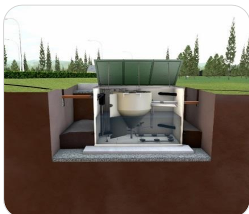
Obr. b5) Napouštění a obsyp ČOV
